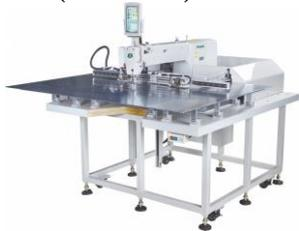
Швейный автомат программируемой строчки с прямым приводом, с 2-х ступенчатой пневматической системой прижима изделия, в области шитья 600x400 мм, с автоматическими функциями. Наиболее удобен для шаблонного шитья небольших изделий по заданному контуру. Широкая область применения машины при пошиве кожаных сумок, декоративных элементов интерьера автомобилей. Автоматические функции: закрепка, позиционер иглы, обрезка нити. USB-порт
