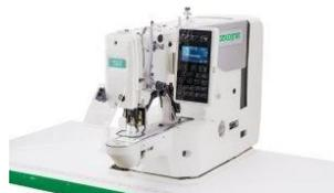
Одноигольная закрепочная машина челночного стежка, с электронным управлением, с прямым приводом, с автоматической обрезкой нити.
